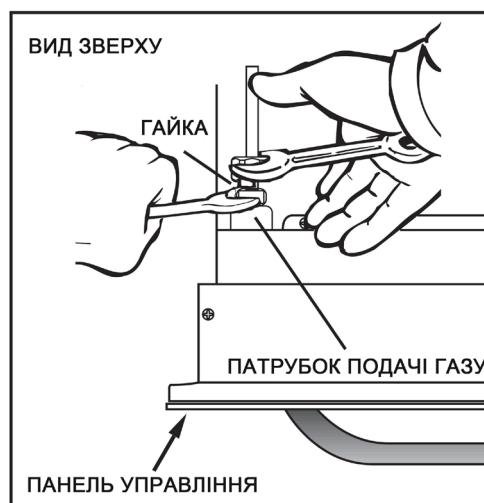
2 . Затягніть гайки ключем 22. Робіть це обережно, щоб не зрушити патрубок з місця і не докласти небажані навантаження на систему подачі газу в приладі.
