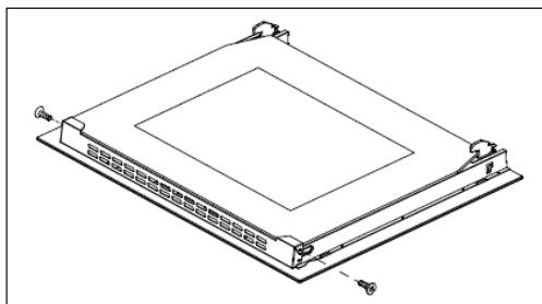
**УВАГА:** Запам'ятайте порядок зняття скла, щоб при зворотньому встановленні не порушити порядок розміщення кожного скла.
