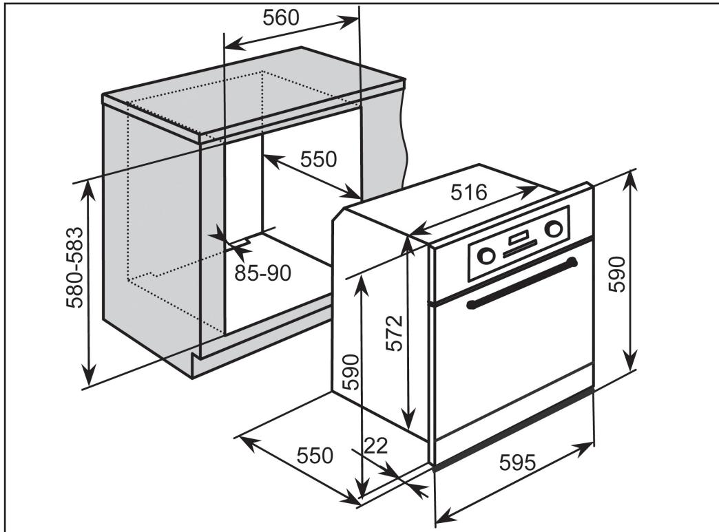
Духова шафа може бути встановлена у стандартний отвір: як під стельницею (рис. 1), так і в колоні (рис. 2).
