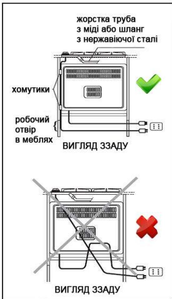
Вимикач не повинен розмикати жовтий / зелений кабель заземлення. Фазовий кабель коричневого кольору (йде від виведення "L" клемної колодки) повинен бути підключений до фази мережі електро живлення.
