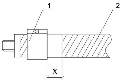
1 – диффузор; 2 – шланг горелки
