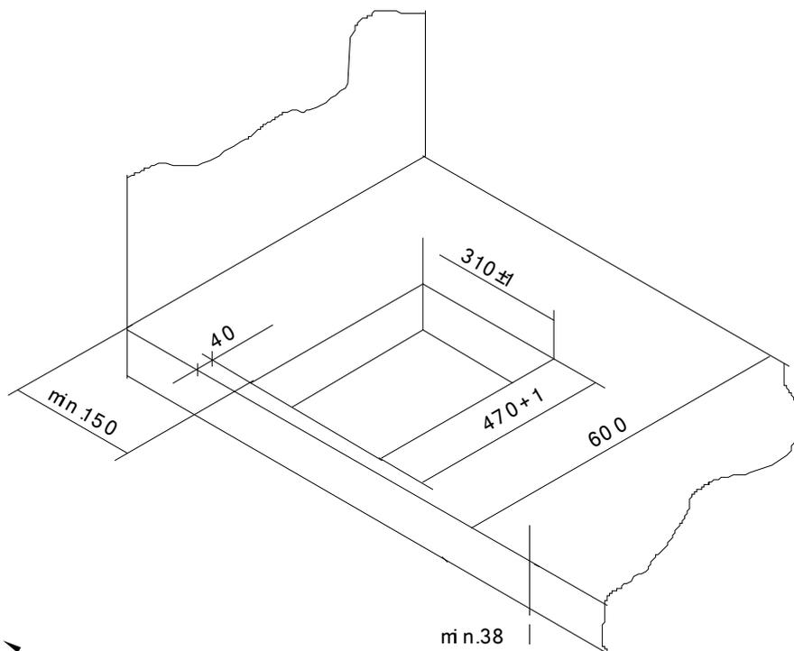
**Рис. 3** Способ монтажа
